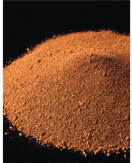
**BC. ATOX Scon bindet Schwefelwasserstoff als schwerlösliches Eisensulfid.**
