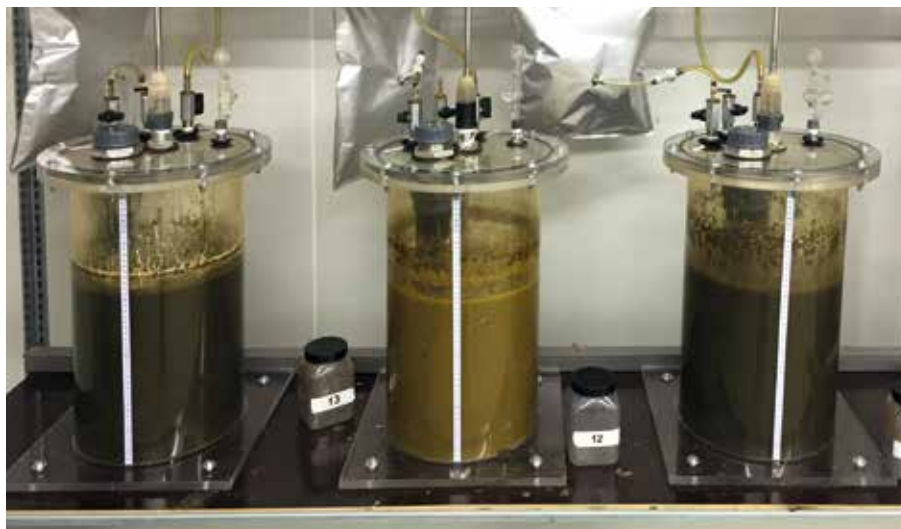
Panta Rhei – alles fließt – Substrat-Beispiel aus 90 % Hühnermist mit 7,8 g NH 4 + und 90 g/l oTS – in den Labor-Fermentern der ISF Schaumann Forschung
