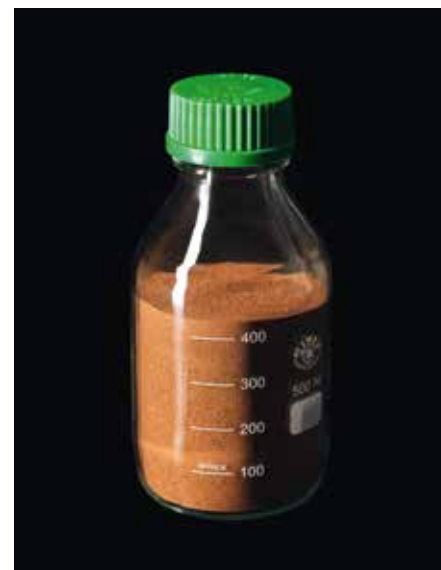
BC. ATOX Scon bindet Schwefelwasserstoff als schwerlösliches Eisensulfid.
